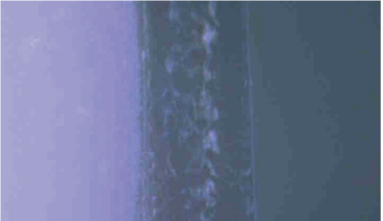
Abbildung 1: Digitalmikroskopaufnahme eines Mikrotomschnittes von Muster 1 (Vergrößerung: 1.000fach).
