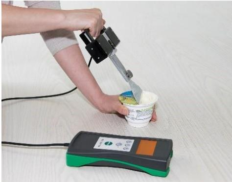
*Trennkraft-Messgerät im Einsatz beim Öffnen eines Joghurtbechers*
