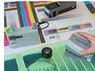
Für eine Druckmaschinenabnahme ist mit einem Zeitaufwand von 6-8 Stunden vor Ort zu rechnen, wobei die Daten für die notwendigen Testformen vom SID vorab bereitgestellt werden. Die einzelnen Testformen werden nacheinander mit unterschiedlichen Druckbedingungen gedruckt und die vorgeschriebene Menge Druckexemplare entnommen.
